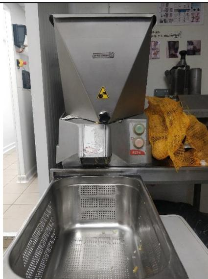
2. Fais un trou dans le filet de pomme de terre, allume la machine en appuyant sur le bouton vert et dépose les pommes de terre en haut.
